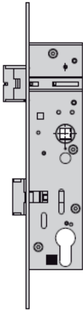
Serrure BKS 19 EVP PZ ø 17 mm Fonction panique (B 1916 E) B 1916 9003 DIN gauche, 1 vantail B 1916 9004 DIN droite, 1 vantail Gâche Jansen combiné (EA-B 515, 03.11.09)
