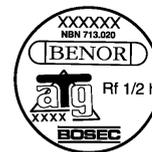
Cette marque est apposée en usine par le fabricant sur la partie supérieure du chant du vantail, du côté des paumelles.
