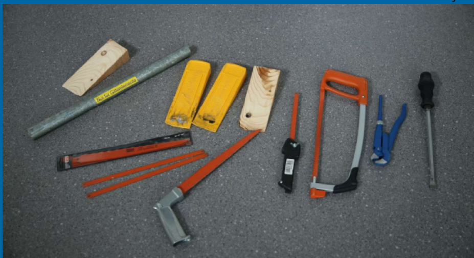
Fig. 5: Voorbeeld van een gereedschapsset ("tool set") A2 voor de manuele aanval op inbraakwerende elementen van klasse 2 volgens de norm EN 1630.
