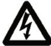
Warnung vor gefährlicher elektrischer Spannung
