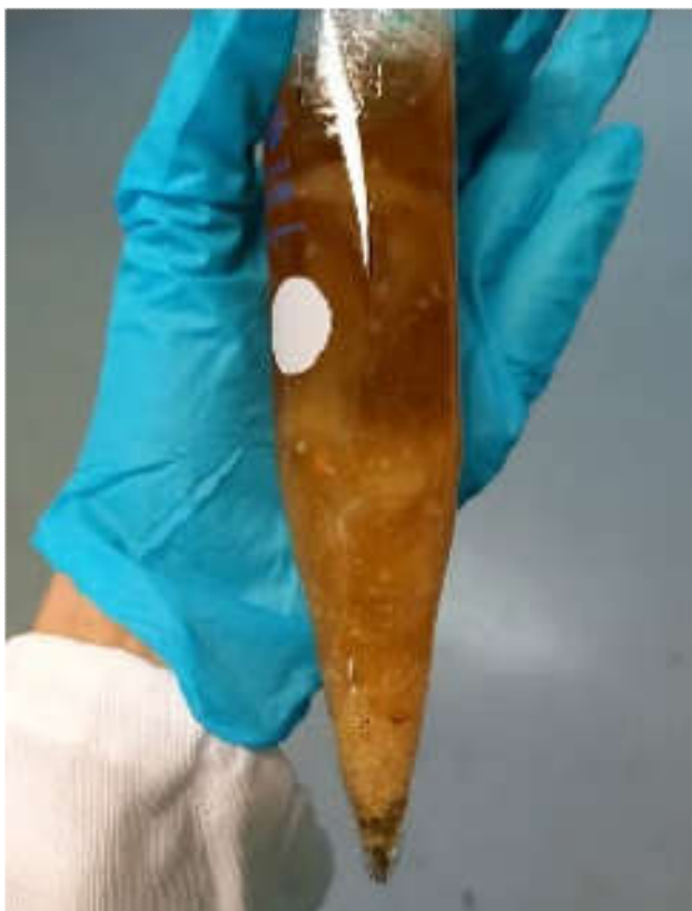
Fig. 3 : Taux de sédiments largement supérieur aux exigences imposées par les normes européennes et la Notice Technique ANPI NTN 168.
